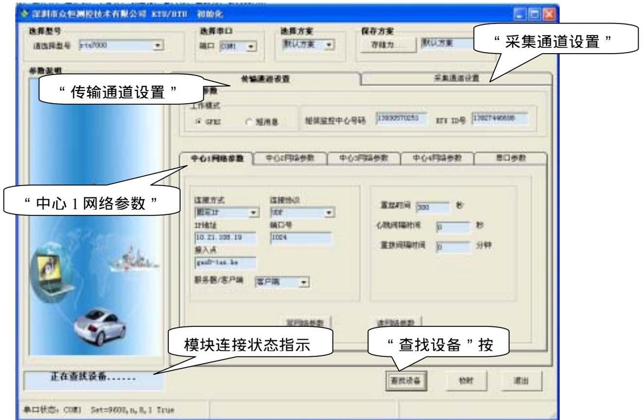
如 10 秒钟后，此提示框未显示“找到 RTU 设备”，则模块连接失败。需重复上述过程或给模块断电后点击“查找设备”按钮再给模块重新上电，以重新连接模块。
